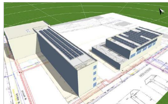
Bild 19 Energ. Sanierungskonzept: PV-Anlage CO 2 neutral, Belegungsbsp.
