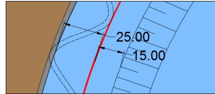
Kaimauer zurück gesetzt Flachwasserbereich B = 40 m
