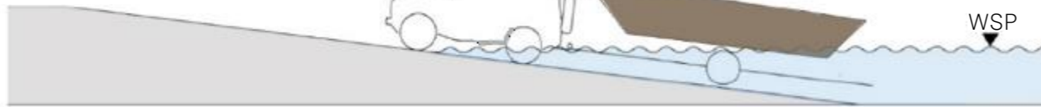
Sliprampe zu steil
