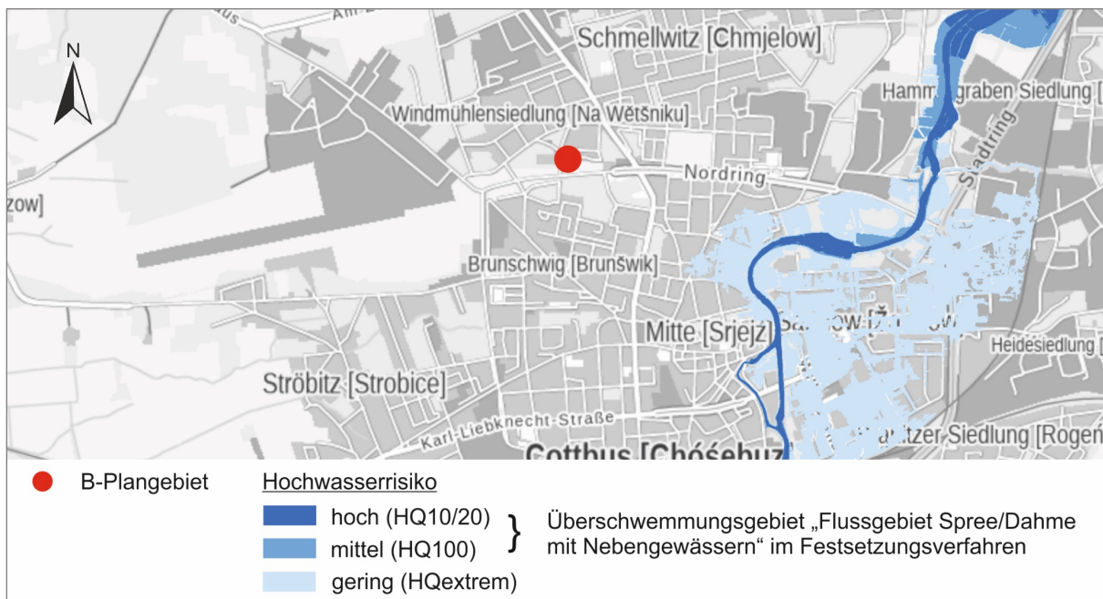
Abbildung 2.9: Hochwasserrisiko- und Überschwemmungsgebiete (LFU 2025a)
