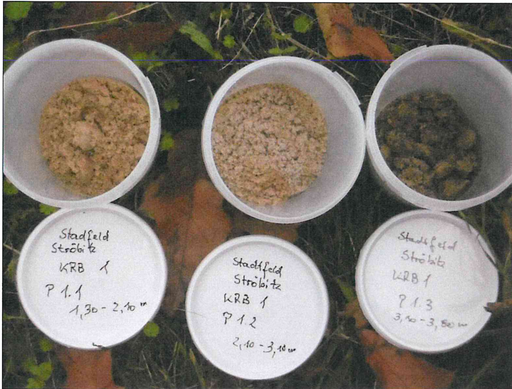
Foto 9: Aus KRB 1 entnommene Bodenproben zur Kerngrößenanalyse (Siebanalyse)
