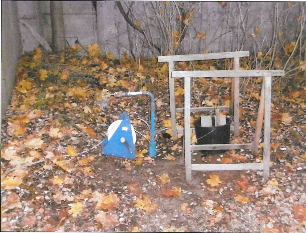
Foto 1: Mit Unterwassermotorpumpe MP 1 und Steigrohr behangener Rammpegel P 1
