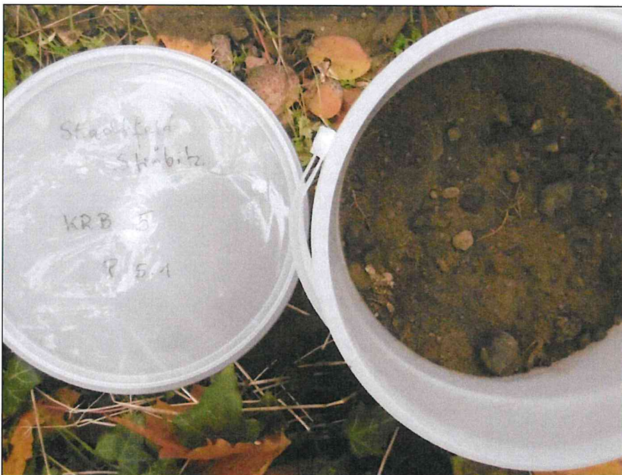
Foto 34: Probe P 5.1 aus Auffüllungsmaterialien KRB 5A
