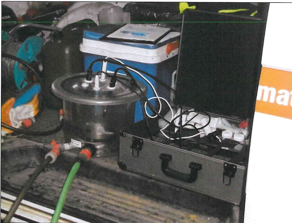
Foto 2: Durchflußmeßzelle mit Vor- Ort - Meßgeräten
