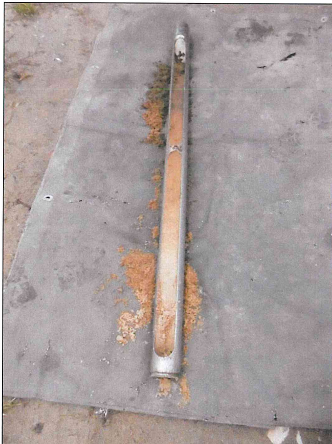
Foto 4: Bohrkern KRB 10 vom 0,00 – 1,00 m
