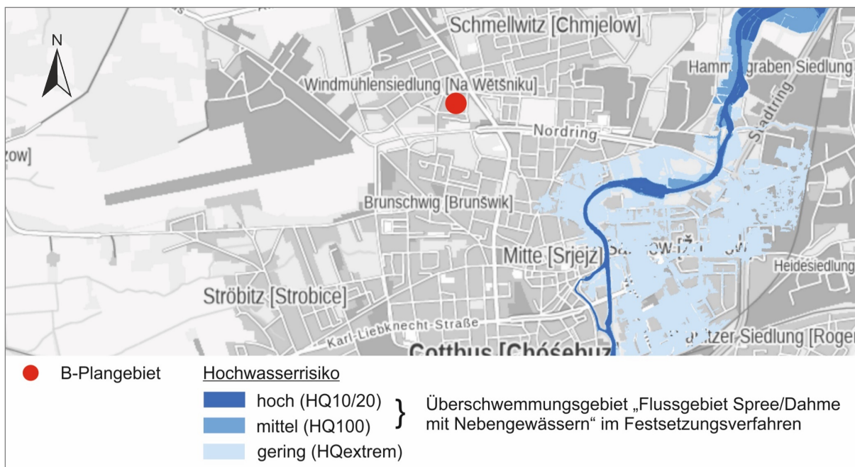
Abbildung 2.9: Hochwasserrisiko- und Überschwemmungsgebiete (LFU 2025a)
