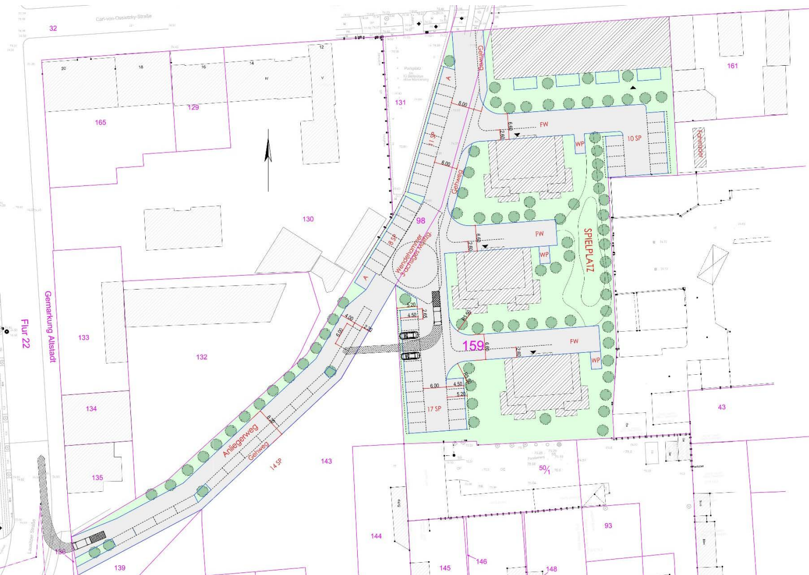
Abbildung 9: Verkehrliche Erschließung mit Wendehammer
