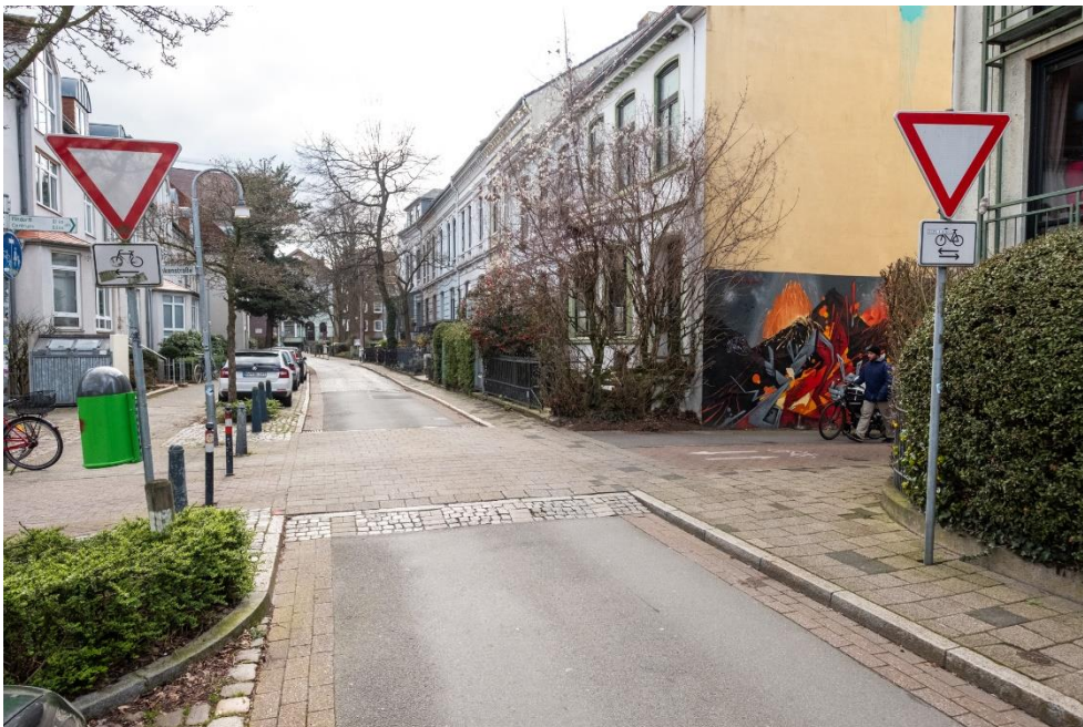
Abbildung 44: Aufgepflasterte und bevorrechtigte Querungsstelle des Radverkehrs (Bsp. Bremen, Quelle: IGS)
