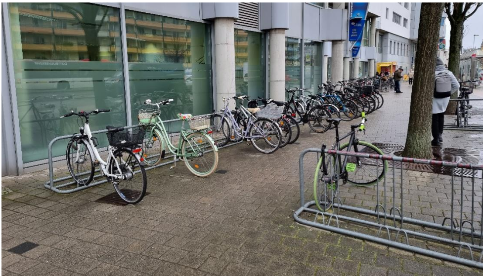
Abbildung 23: Vorderradhalter ohne Rahmenanschießmöglichkeit im Umfeld der Spree Galerie (Quelle: IGS)
