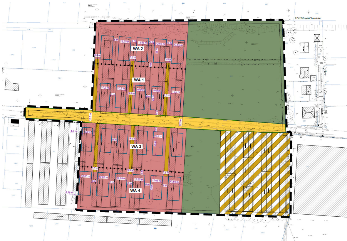
Abb. 2: B-Plan Vorentwurf "Grenzstraße – Wohngebiet 2" OT Gallinchen. Stand: Januar 2021; grün: Flächen für Wald; rot: Flächen für Allgemeines Wohngebiet; gelb: öffentliche Straßenverkehrsfläche; dunkel gelb schraffiert: Verkehrsfläche besonderer Zweckbestimmung, hier: ruhender Verkehr; blaue Linien: Baugrenzen;
